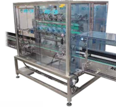
Sopladora/enjuagadora lineal alternativa. Pensado para bajas-medias velocidades de producción.
